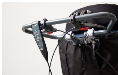
Bremsegrebene er monteret på skubbebøjlen.
