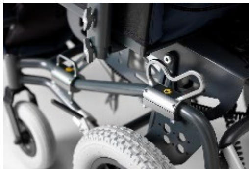
Anvend udelukkende Tie-Down-beslagene sammen med godkendte fastgørelsessystemer, der overholder EU-forordning 214/2014.
