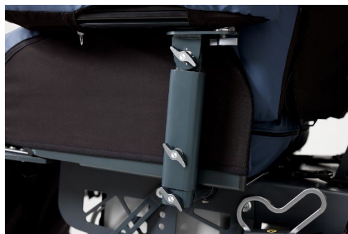
Nederste fingerskrue sikrer, at armlænet kan tages af. Midterste fingerskrue justerer højden. Øverste fingerskrue vinkler armlænet frem, tilbage, ind og ud (swing away).
