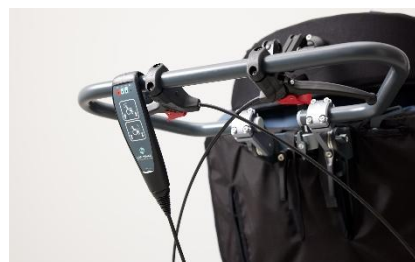
Bremsegrebene er monteret på skubbebøjlen.
