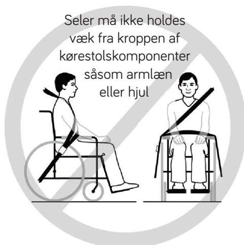
Figur 3a – Forkert positionering af bækkenseler over kørestolsstøtter.
