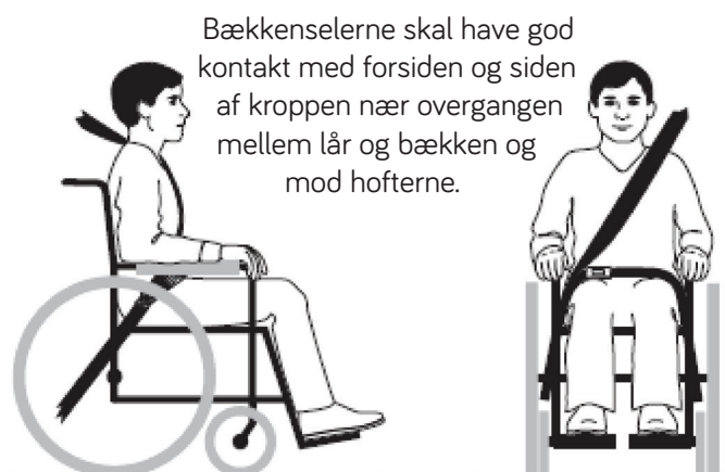
Figur 3b – Korrekt føring og positionering af seler på kørestolspassageren.
