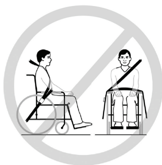
Figur 3a – Forkert positionering af bælteselen over kørestolsstøtter.
