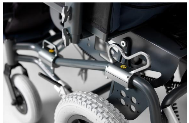
Der Schiebebügel des Kamille Komfortrollstuhls kann ganz nach oben geneigt werden, z. B. wenn der Rollstuhl in einen überfüllten Aufzug einsteigen und wieder aussteigen soll
