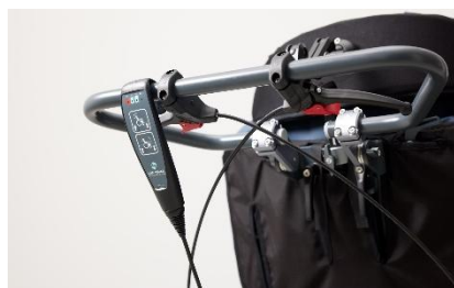
Bremsegrebene er monteret på skubbebøjlen.
