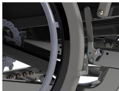
Cobi Cruise è dotato sia di freni a mano che di freni a disco.
