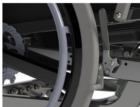
Cobi Cruise komfortkørestol er udstyret med både håndbremses og skivebremses.
