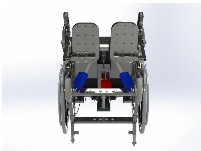
To aktuatorer (markeret med blåt) styrer tilt funktionen. Én aktuator (rød) styrer recline.
