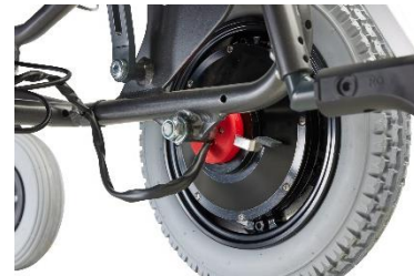
Det sorte frigeare-håndtag trykkes ned (på begge hjul) ved behov for frakobling af de to motorer.
