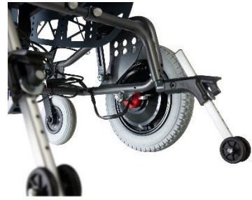
Påmonteret anti-tip, der kan justeres efter terrænet.
