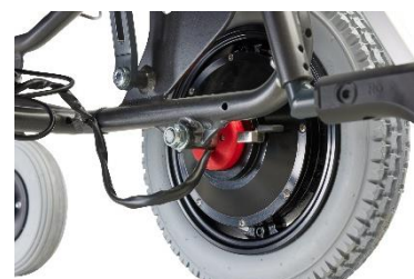
Det sorte frigeare-håndtag skubbes op (på begge hjul), når de to motorer skal tilkøbes.
