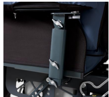
Nederste fingerskrue sikrer, at armlænet kan tages af. Midterste fingerskrue justerer højden. Øverste fingerskrue vinkler armlænet frem, tilbage og ud (swing away).
