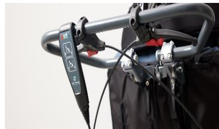
Bremsegrebene er monteret på skubbebøjlen.
