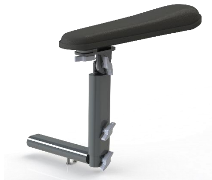
Armlæn med tre fingerskruer på siden. Nederste skrue sikrer, at armlænet kan tages af. Midterste skrue justerer højden. Øverste skrue vinkler armlænet frem, tilbage og ud (swing away).
