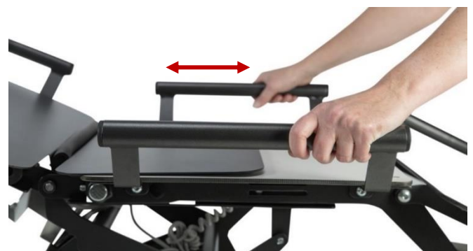
3. Tag fat i rammens håndtag og træk ud eller skub ind til ønsket position. Boltene i begge sider skal igen låses. Træk eller skub igen rammens håndtag indtil der høres et klik. Rammens håndtag er nu låst.
