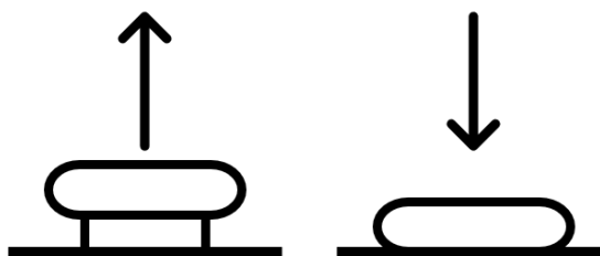
FitGo-systemet består af en drejeknap. Knappen aktiveres, når den trykkes ned. Skal knappen løsnes, trækkes den op, hvorefter snoretrækket frigives.
