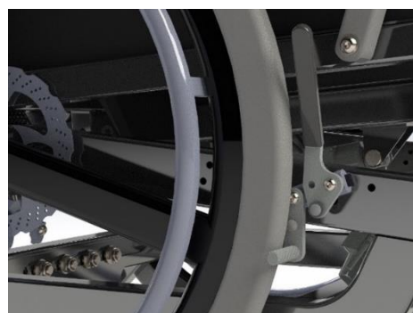
Cobi Cruise er udstyret med både håndbremseser og skivebremseser.
